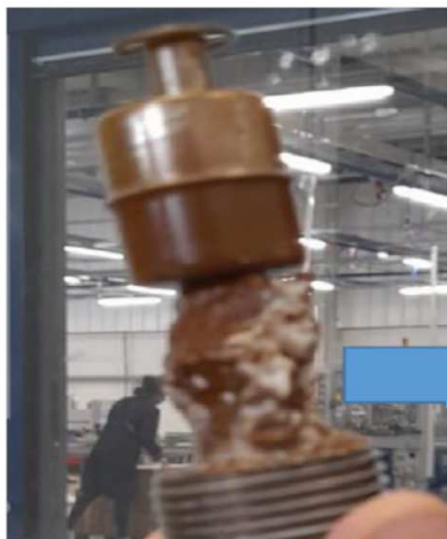
Flotteur fortement entartré d'un réchauffeur, avant installation d'un Ring Phi DN20 (octobre 22)
