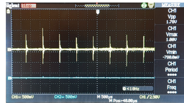
Test 1 : réponse à des impulsions régulières (1,5V crête à crête)
